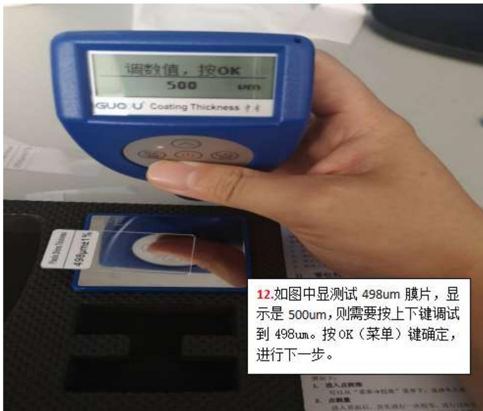
**12.**如图中显示测试 498um 膜片，显示是 500um，则需要按上下键调试到 498um。按 OK (菜单) 键确定，进行下一步。
