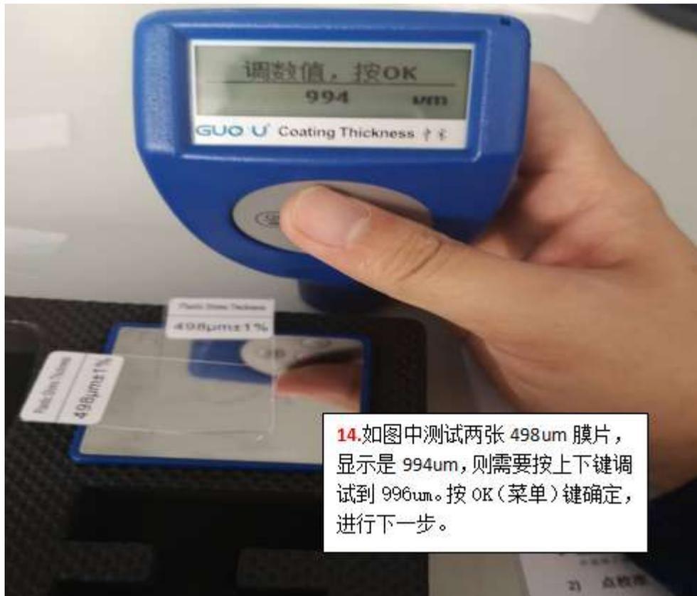
**15.**测试完，按 OK (菜单) 键确定保存。五点校准完成。
